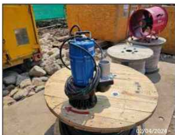
รูปที่ 2-31 เครื่องสูบน้ำแรงดันต่ำสำรองประจำพื้นที่ก่อสร้าง
